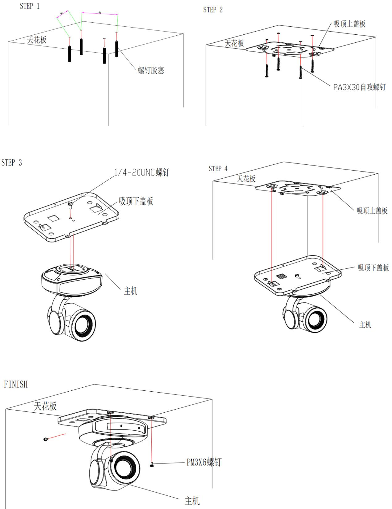
图 1-3 支架倒装步骤
